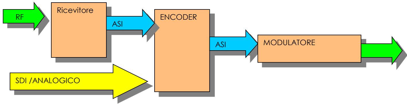
Vengono proposta una soluzione tecnologica , per un apparato integrato che permette di trasmodulare segnali DVB-T2 ,in DVB-T in modo da rendere fruibili i contenuti ai tv con tuner digitale DVB-T HD (h264) integrato in commercio senza l'uso di un decoder esterno, con la possibilità di aggiungere anche contenuti da una sorgente esterne ( es decoder) o un segnale di contribuzione digitale ( sdi ).
